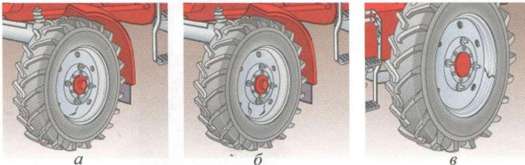
1. Имеется одна трещина диска колеса (а).
