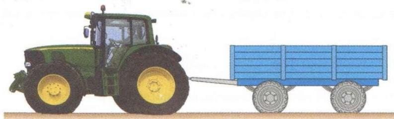
1. Электрооборудование прицепа должно быть подключено к системе электрооборудования самоходной машины.
