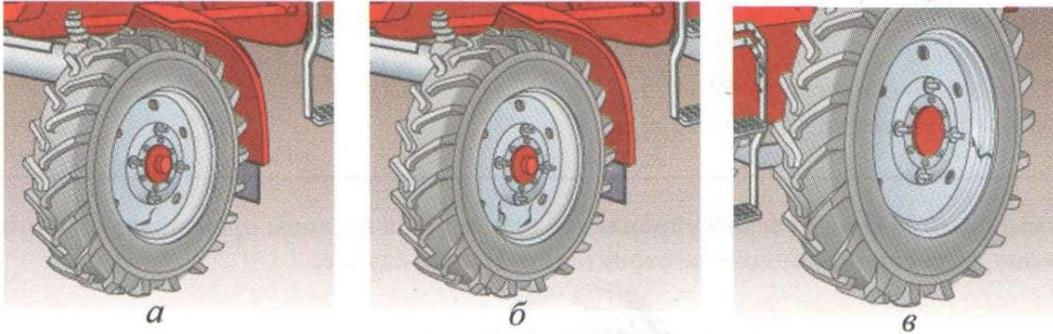
1. Имеется одна трещина диска колеса (а).
